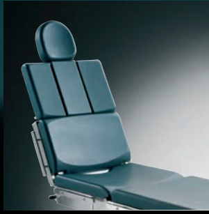
61385 Rückenplatte für Schulteroperationen zur Anbringung am Beckenteil an Stelle der Beinplatten, Einstellung über Gasdruckfeder, 3 abnehmbare Schultersegmente, mit Kopfplatte und Polster Back plate for shoulder operations, to fix at pelvis part instead of leg plates, gas spring adjustment, 3 detachable shoulder parts, incl. head rest and pads
