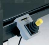
Joystick zur einfachen Steuerung der Längs- und Querverschiebbarkeit
